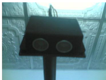
ภาพที่ 4.5 ชุดตรวจวัดระยะความสูงใช้โมดูล SRF05
